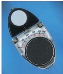
Abbildung eines einfacheren Luxmeters
