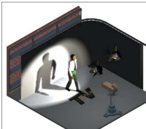
*Aufhell-Licht über Stufenlinsenscheinwerfer (linkes Gerät)*
